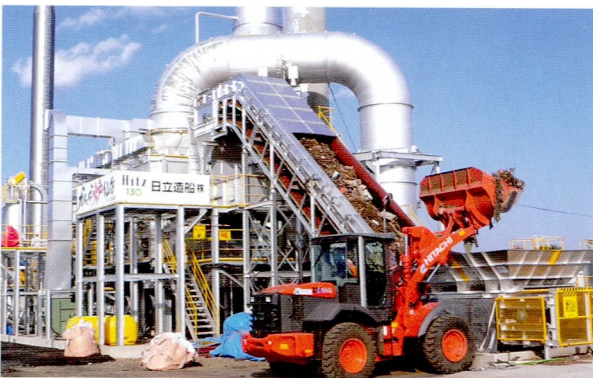
震災廃棄物発生量は135万トン、津波堆積物は130万トンと推計。仮設焼却炉の1日あたりの処理能力は、蒲生90トン、荒浜300トン、井土90トン
