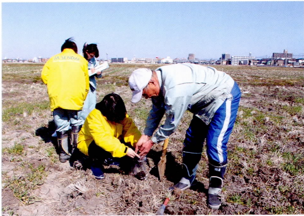
除塩に先立ち、津波被災農地の土壌塩分濃度や用排水系統など基本情報を得る調査を実施した【JA仙台提供】
